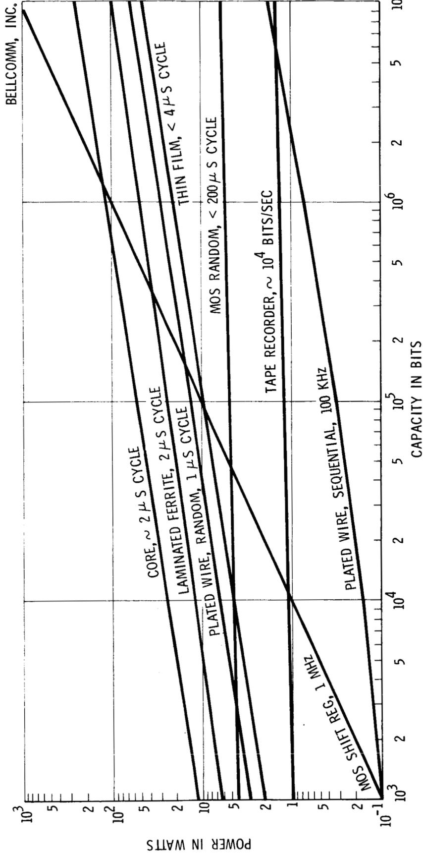
FIGURE 3 - MEMORY POWER vs. CAPACITY (1970 - 1972)
