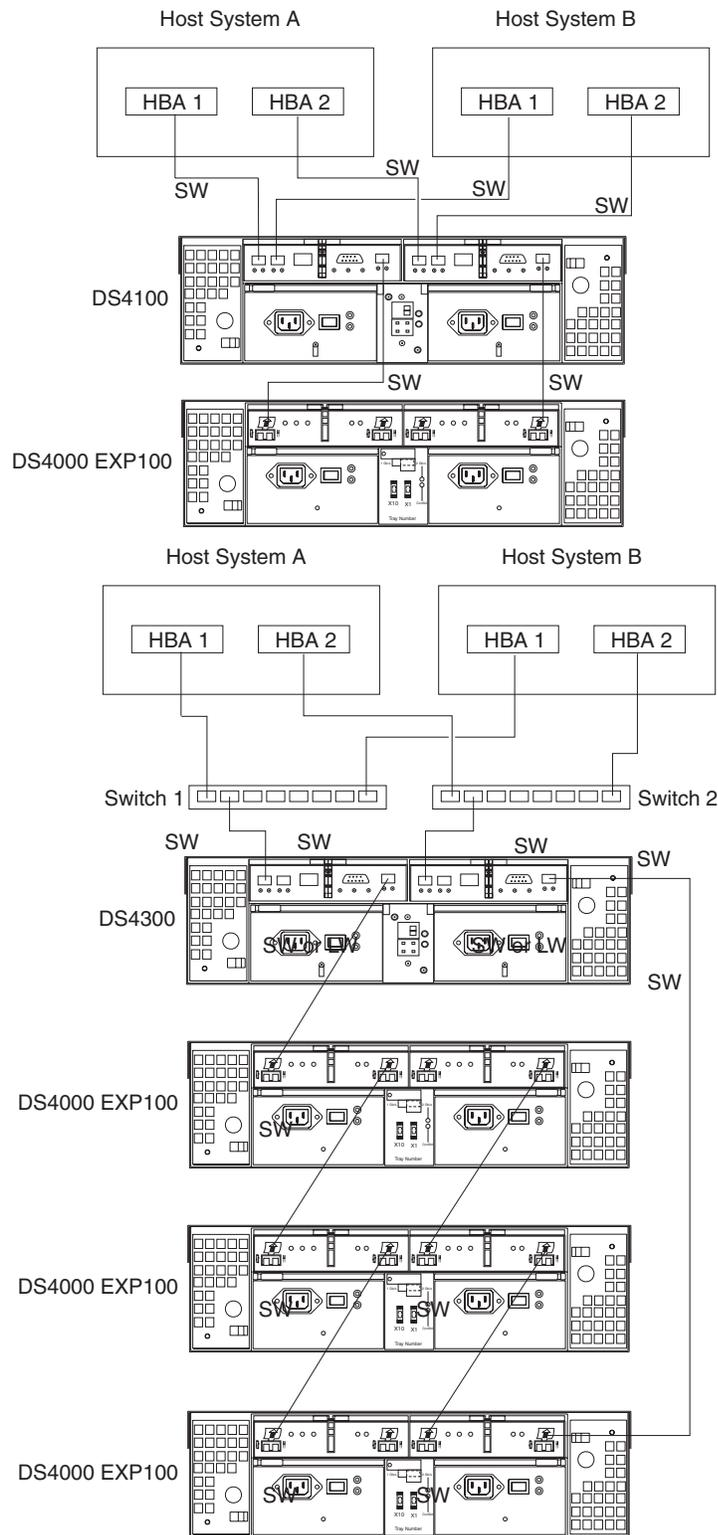
Figure 99. DS4100 and DS4300 Drive Attach Examples
