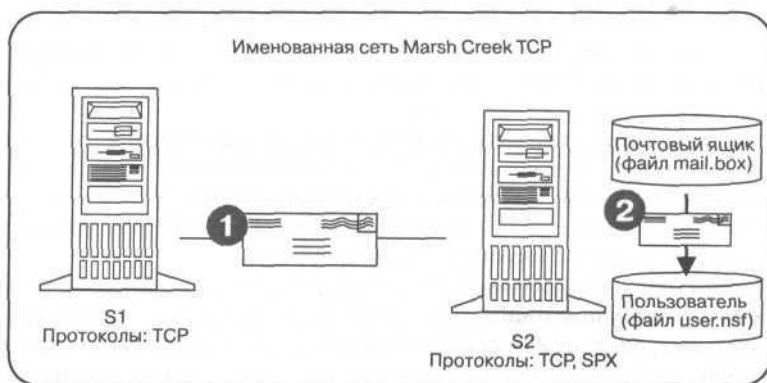
Рис. 8.2. Сервер S1 располагает сообщением, адресованном пользователю сервера S2. Начинается немедленная доставка сообщения с сервера S1 на сервер S2 без привлечения документа соединения
